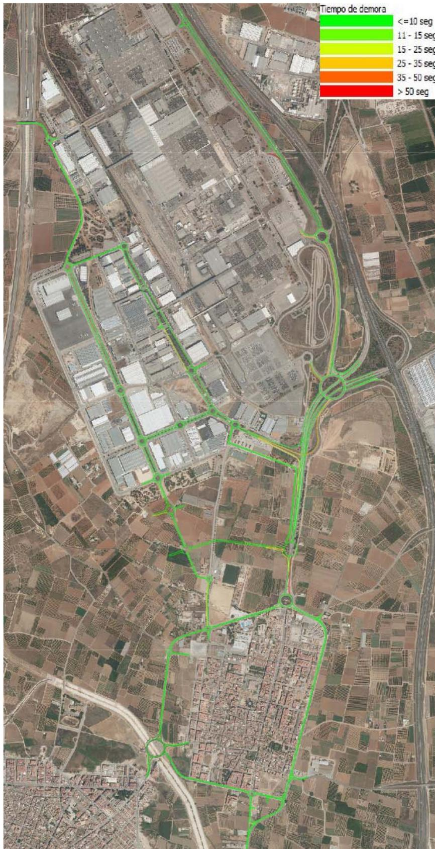
*Ilustración 24. Resultados de los niveles de servicio de flujo-capacidad y tiempo de demora. Fuente. Elaboración propia a partir de los datos de AIMSUN.*
