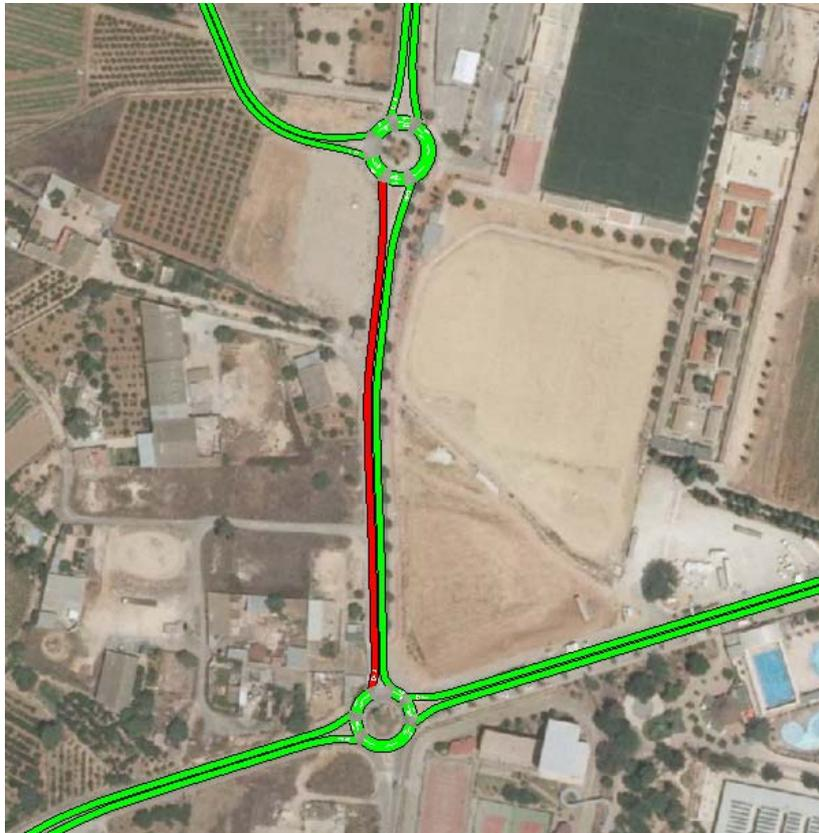
*Ilustración 11. Conexión entre rotonda de unión de las Av. Henry Ford y calle Eje H.P.I. Juan Carlos I con la rotonda de la Av. Antoni Ludeña. Fuente. Elaboración propia a partir de los resultados de AIMSUN.*
