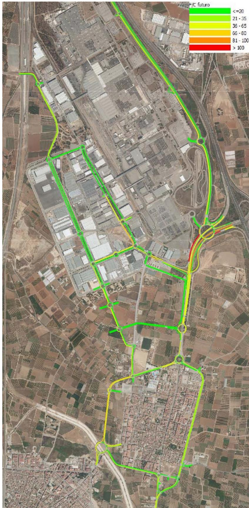
Ilustración 23. Análisis de la capacidad del viario. Fuente. Elaboración propia a partir de los resultados de AIMSUN.
