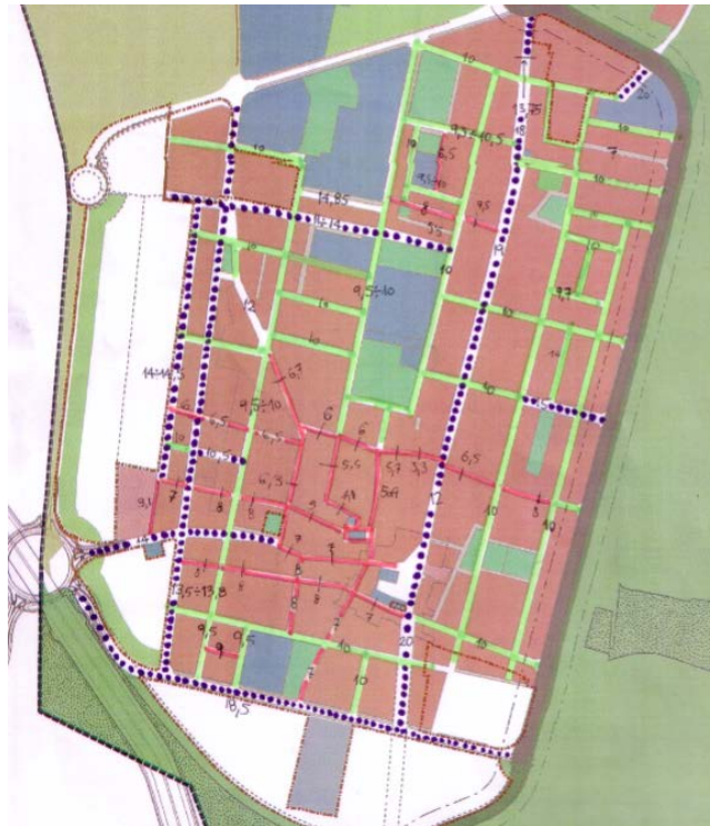
Ilustración 23. Secciones tipo en el municipio de Almuñécar. En color morado y punteadas, las calles de ancho mayor a 10 metros. En color verde se identifican las calles de ancho 10 metros y en color rojo las calles de ancho menor a 10 metros. Fuente. Elaboración propia.
