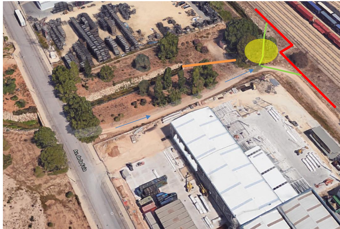
Imagen 5. En rojo aparece grafiado el límite de Ford/polígono. En naranja aparece grafiado el trazado del marco esviado de cruce de la acequia. Sombreada en amarillo aparece grafiada la zona con acumulación de cañas en la desembocadura del marco. En azul aparece grafiado el sentido de acceso del agua en caso de lluvia torrencial. En verde aparece grafiada la zona de acumulación de agua que impacta con el muro medianero que no desagua en el canal (ver imágenes 6 y 7). Elaboración propia
